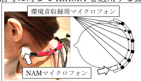
図1：空気/体内伝導マイクロフォン
