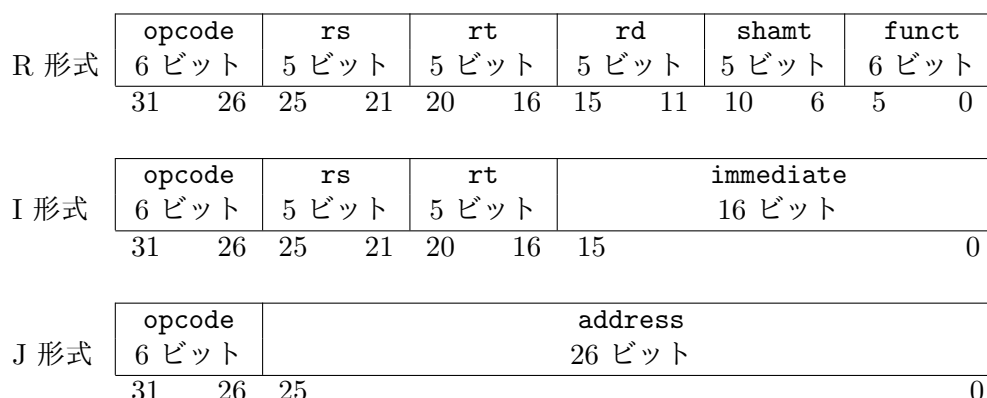
図 2: MIPS の命令のフィールド構成
