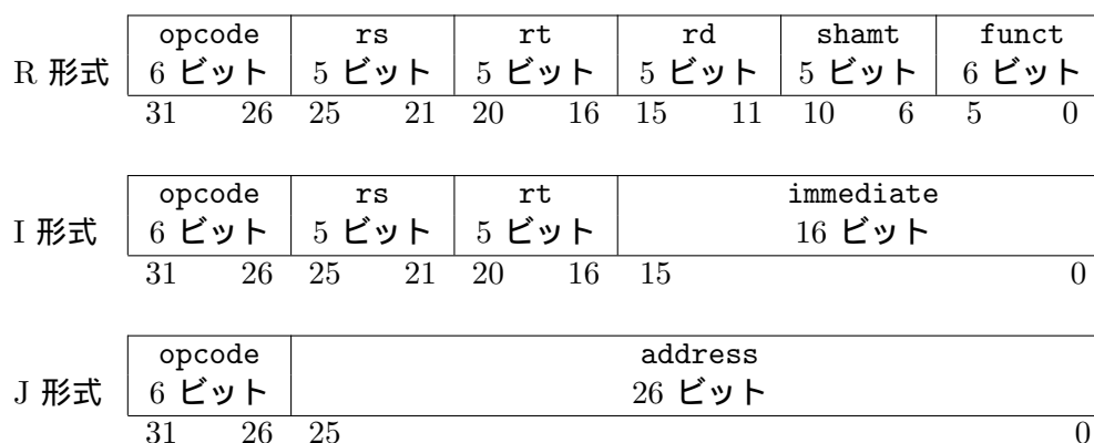
図 2: MIPS の命令のフィールド構成
